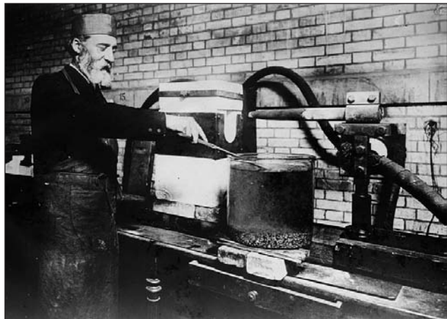
FIGURA 3. Henri Moissan al seu laboratori, temperant un gresol de grafit amb ferro fos per tal d'obtenir diamants sintètics. En segon pla es pot veure el forn i un dels elèctrodes amb què obtenia temperatures de fins a 3 000 °C.
